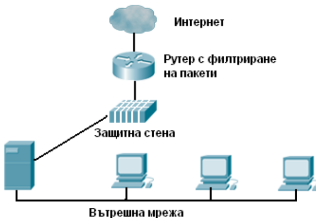
Фиг. 3.1 Проста архитектура на защитна стена
